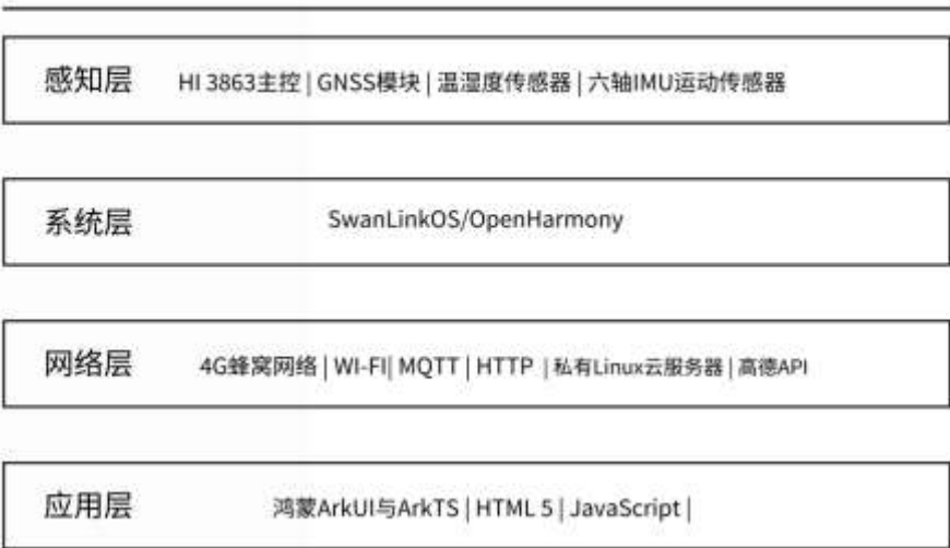
4.1 基于OpenHarmony的低功耗宠物动态感知与定位系统四层总体架构图
